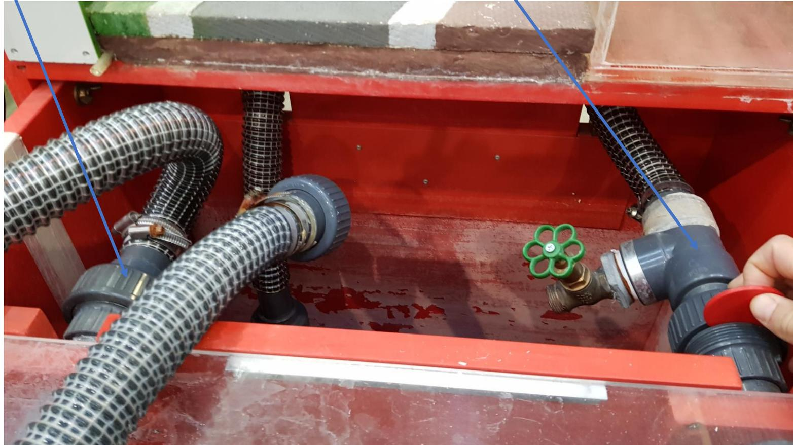
Pour vider complètement la maquette, une vis doit être desserrée sur le bord inférieur du réservoir.
