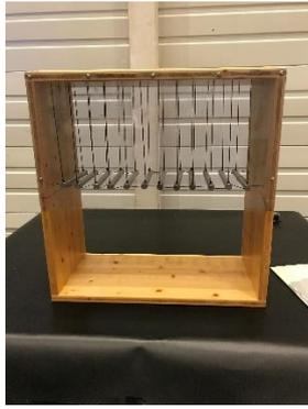
À travers ce dispositif, on peut montrer comment se propagent des ondes sismiques dans deux directions
