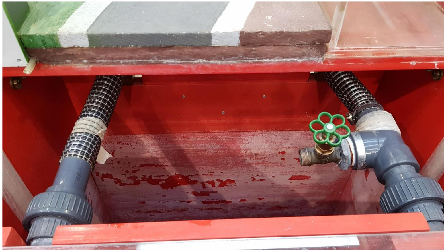
Pendant les démonstration, la grille métallique est placée au-dessus du réservoir. Cela permet de récupérer les pièces qui sont emportées par l'eau et de les empêcher d'entrer dans la pompe.
